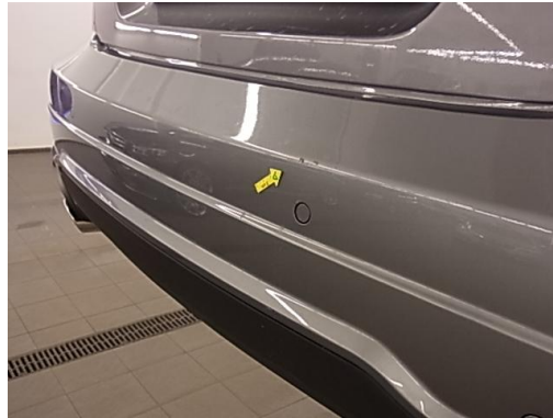
5. Stoßfänger hinten Kratzer smartrepair/ Blende unten Kratzer
