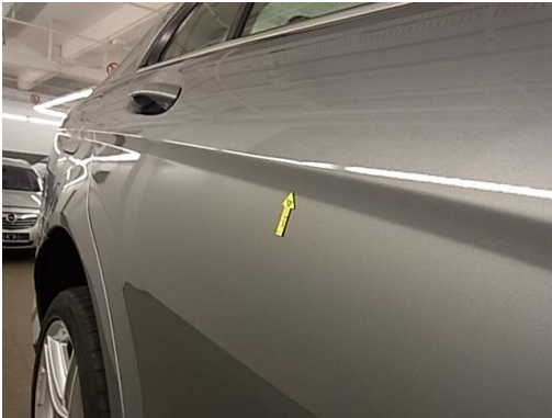
4. Tür hinten rechts Delle smartrepair
