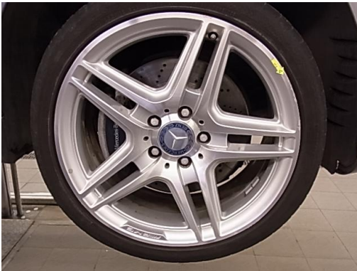
8. Rad vorne rechts Felge beschädigt
